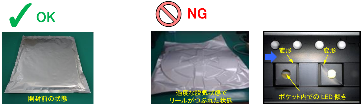
図 4. 過度な脱気状態によるエンボスキャリアテープの変形
